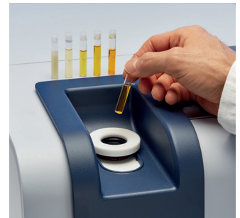
煩わしいサンプル前処理を行わずガラス越しに測定可能です。
