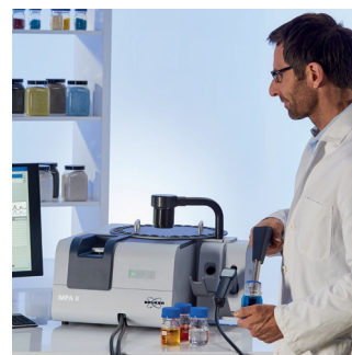
FT-NIR分光法による迅速な原料確認試験
