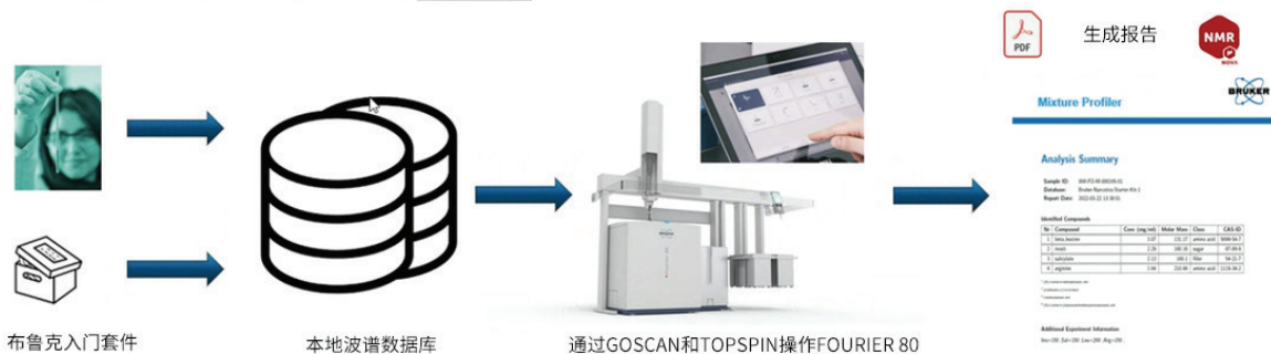
图1: Fourier 80 Mixture Profiler的NMR工作流程概述
